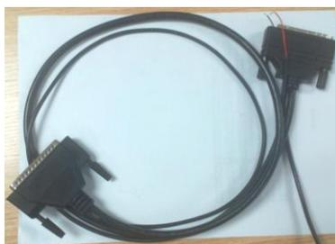
图 8 iLuma 公司提供的 SCSI 68PIN to 37PIN 专用电缆
