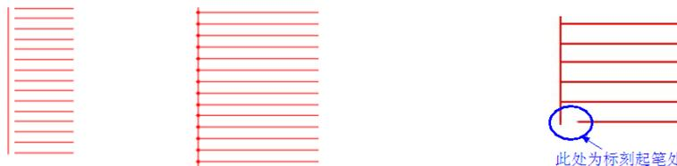
图 25 填充线与边界分离 图 26 前面出现“火柴头”现象 图 27 标刻起笔处与边界分离
